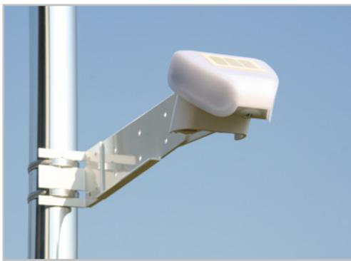
Exemple 2 : montage sur un pylône à l'aide d'un collier de serrage.
