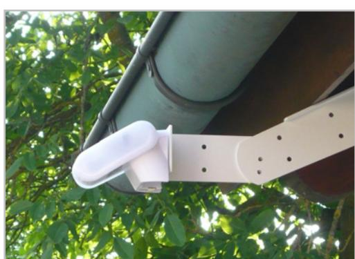
Bsp.1: Durch den Gelenk-Ausleger schaut die Wetterstation unter dem Dachvorsprung hervor. Sonne, Wind und Niederschlag können ungehindert auf die Sensoren einwirken.
