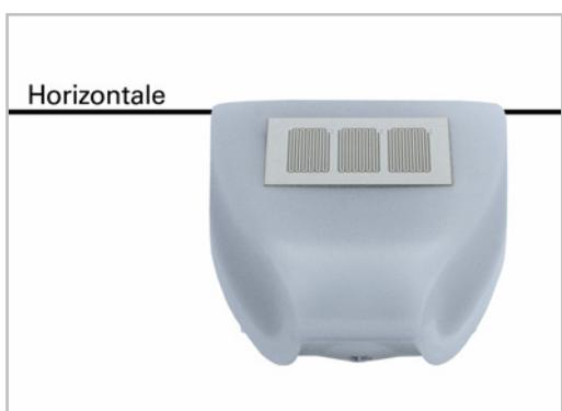
Die Wetterstation muss in der Querrichtung horizontal (waagerecht) montiert sein.
