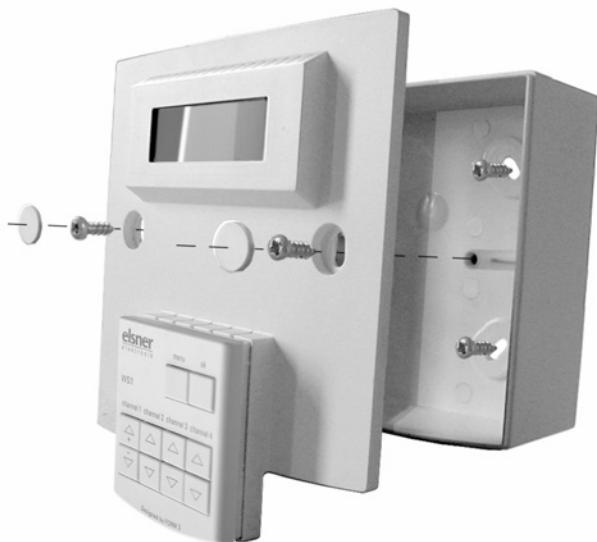
Um das Gehäuse zu öffnen gehen Sie wie in der Abbildung zu erkennen vor. Die Kunststoffabdeckungen für die Befestigungsschrauben der Frontplatte werden bei der Endmontage fest in die Fräslöcher gepresst. Dadurch ist das spätere Entfernen nur schwer möglich und die Abdeckungen werden bei der Demontage beschädigt. Im Gehäuse befinden sich deshalb 3 zusätzliche Ersatzabdeckungen.
